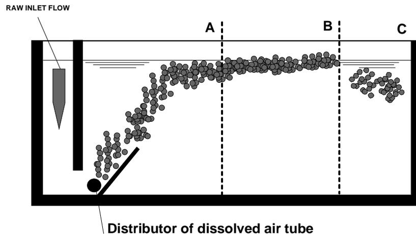
**Figure 7.- Rectangular flotation chamber (CEPIS, 1992).**
