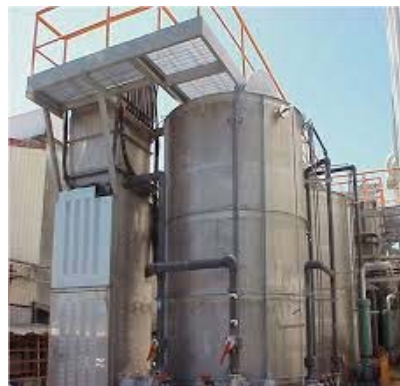
Figura 5. Reactor Fered-Fenton destinado a la oxidación de la DQO no biodegradable del efluente de una fábrica de circuitos impresos en Taiwan. (Fuente: ITRI, www.itri.org.tw )
