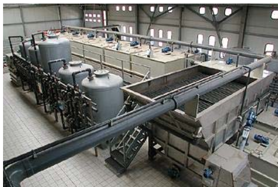
Figura 2. Instalación de tratamiento de aguas residuales industriales mediante un proceso avanzado de oxidación Fenton. Los reactivos requeridos en cada etapa son suministrados a los sucesivos reactores desde los depósitos en los que se almacenan en un proceso de tratamiento totalmente automatizado. La compacidad del sistema se favorece mediante el empleo de decantación lamelar. (Fuente: TECNA, s.l.r., Italia, www.tecna-italy.com )
