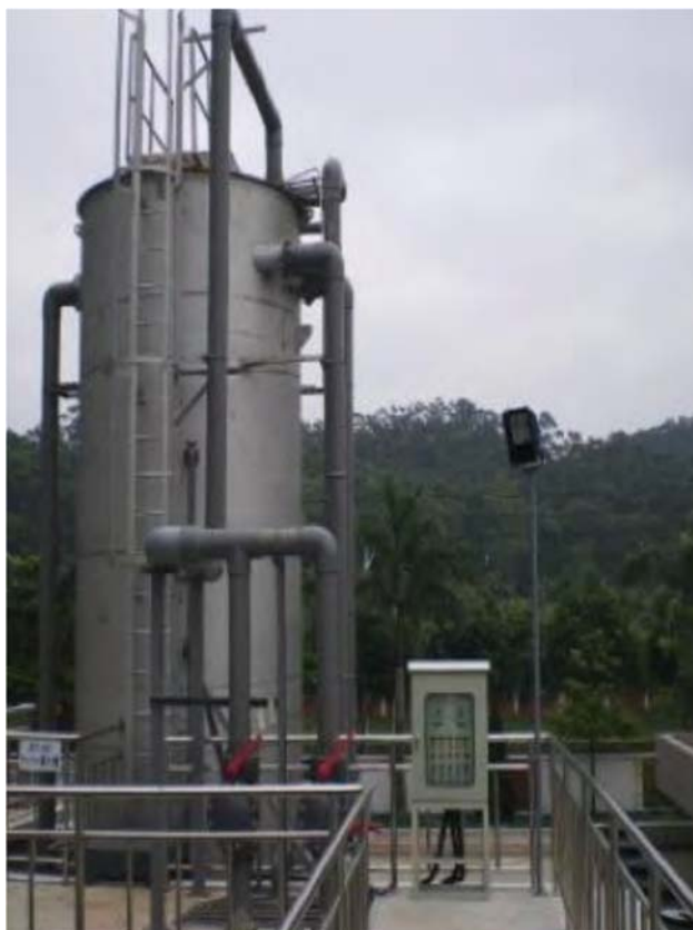
Figura 9. Reactor FBR Fenton. (Century Envirotech Co., Taiwan)
