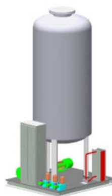
Figura 10. Reactor y esquema de tratamiento de caudales segregados de alta carga orgánica mediante oxidación catalítica Fenton en Schoeller Textiles AG (Suiza), operativo desde 1996 (Schömberger y Schäfer, 2003).
