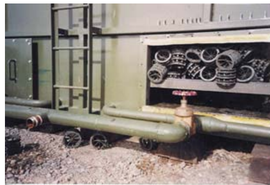
Figura 4.- Imagen derecha: tipología de relleno suelto utilizado en procesos SAF (diámetro medio: 12 a 15 cm). A la izda., un lecho aireado relleno con material suelto tipo Pall-rings (diámetro medio 9 cm).
