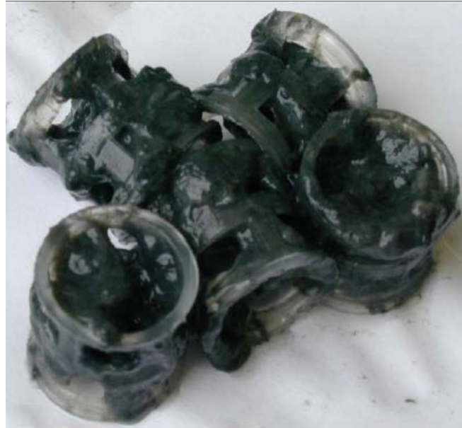
Figura 10.- Biopelícula desarrollada sobre el soporte del SAFTEX. El soporte es tipo Pall-rings o similar.
