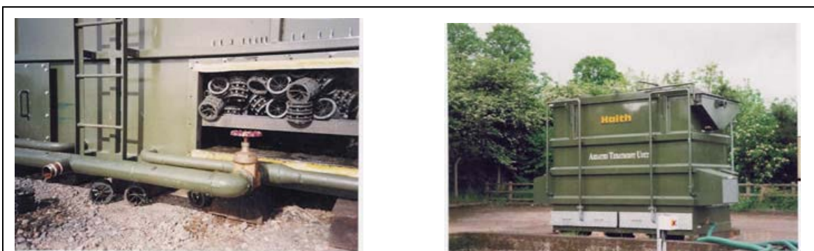
Figura 6.- "SAF" marca Haith, con relleno de piezas sueltas pero no móviles. La superficie específica puede ser de 120 o 210 m 2 /m 3 , no se requiere retrolavados (Cooper-Smith, 2006)
